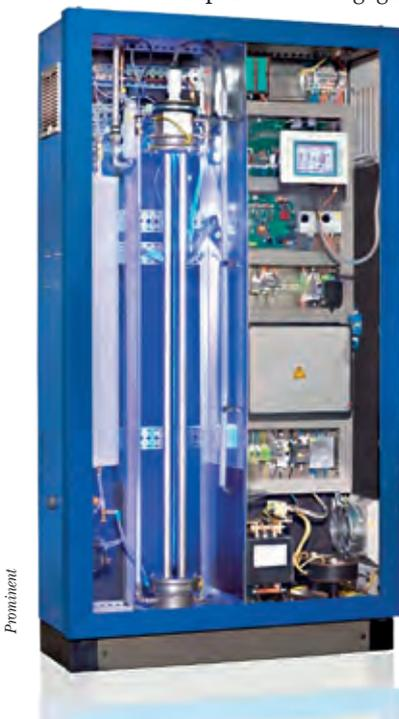
Les ozonateurs OZONFILT<sup>®</sup> OZMa de ProMinent sont des installations sous pression, dans lesquelles le gaz de service, à savoir l'air ou l'oxygène, est introduit sous pression dans le générateur d'ozone. Ils fonctionnent à l'oxygène et permettent une production d'ozone avec des concentrations jusqu'à 150 g/Nm<sup>3</sup>.
