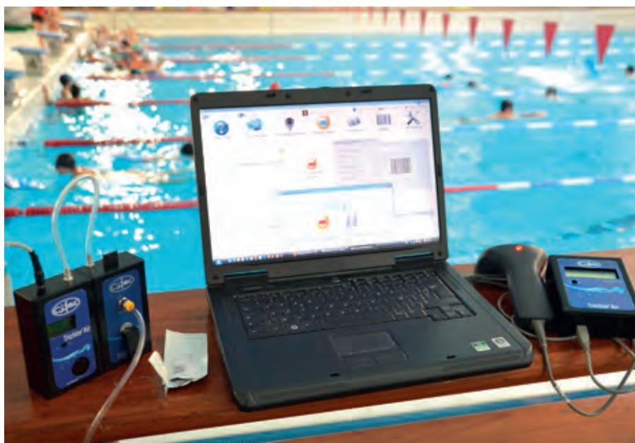
Les déchloramineurs par stripping proposés par Cifec permettent un abattement de 50 % à 80 % des chloramines. L'analyseur Trichlor'air permet quant à lui de mesurer in situ des trichloramines de l'air sans aucune manipulation de produit chimique.
